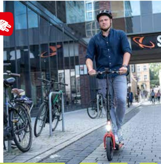
Eric Neubert auf einem nagelneuen, roten WIRO-Scooter. Fünf Stück fahren demnächst auf Rostocker Radwegen. Gas und Bremse betätigen die Fahrer am Griff. Die Höchstgeschwindigkeit liegt bei 20 Kilometer pro Stunde.
