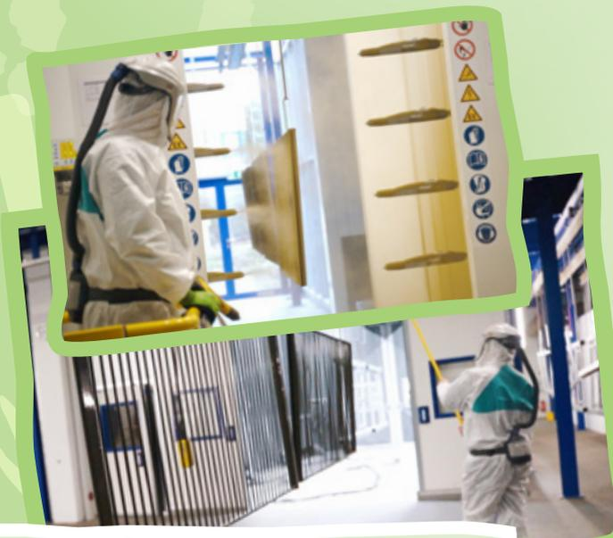
Blick in die Werkhalle: Ein Zaunelement wird in der Automatikkabine mit Farbpulver benedelt. Im Anschluss geht es dann weiter in den Ofen zum Brennen.
